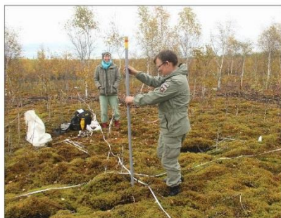
Установка оборудования для наблюдения за грунтовыми водами
